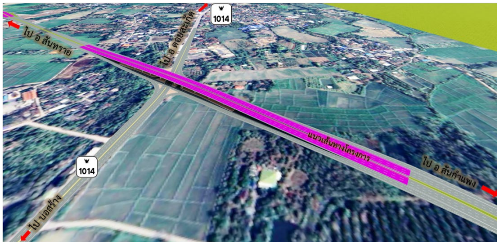
รูปที่ 7-5 รูปแบบทางแยกต่างระดับ ถนนโครงการตัดกับทางหลวงแผ่นดินหมายเลข 1014
