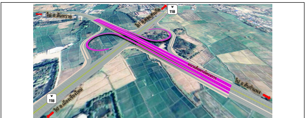
รูปที่ 7-4 รูปแบบทางแยกต่างระดับ ถนนโครงการตัดกับทางหลวงแผ่นดินหมายเลข 118
